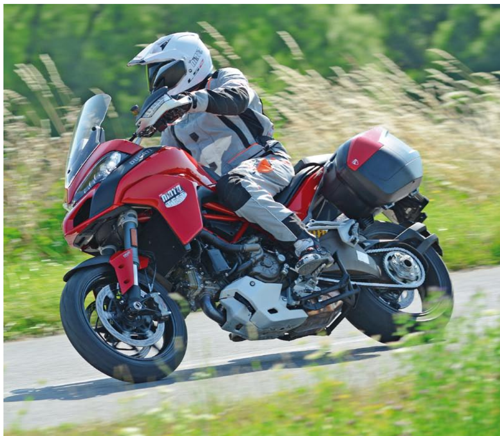
Nová Multistrada dostala úžasné brzdy Brembo Monobloc EVO M50, navyše vybavené náklonovým ABS.
